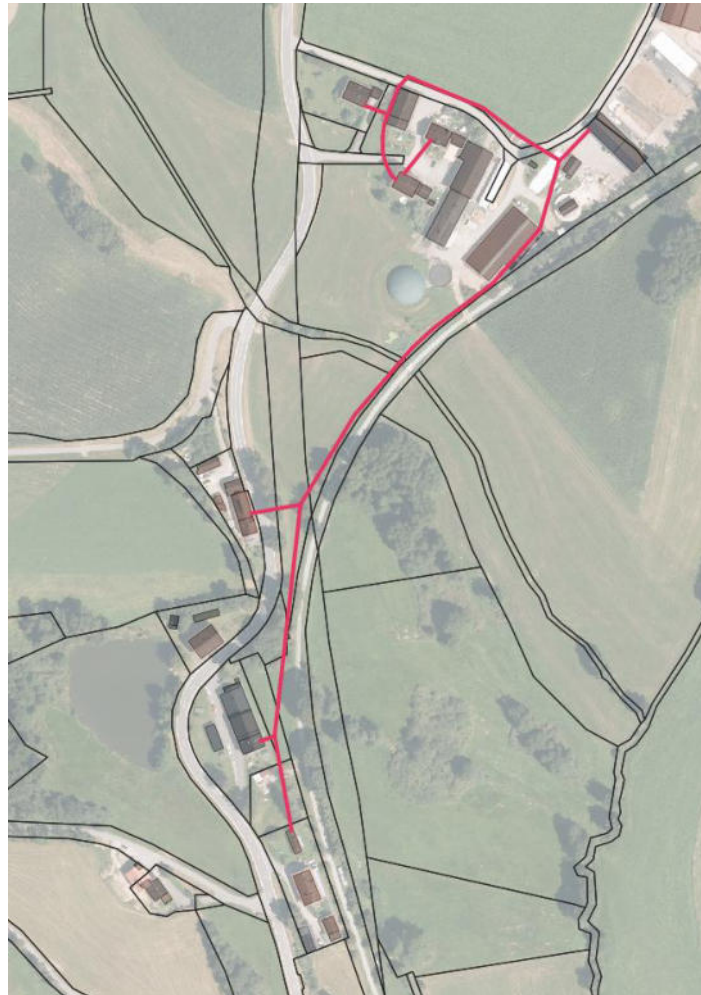
Abbildung 17: Gebäudenetz in Viertl
