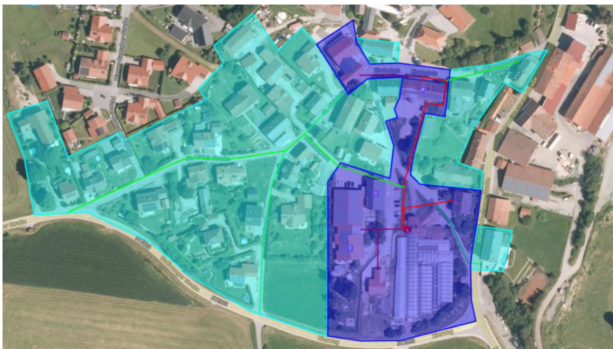
Abbildung 85: Möglicher Trassenverlauf Wärmenetz-Prüfgebiet Konzell-Ortskern
