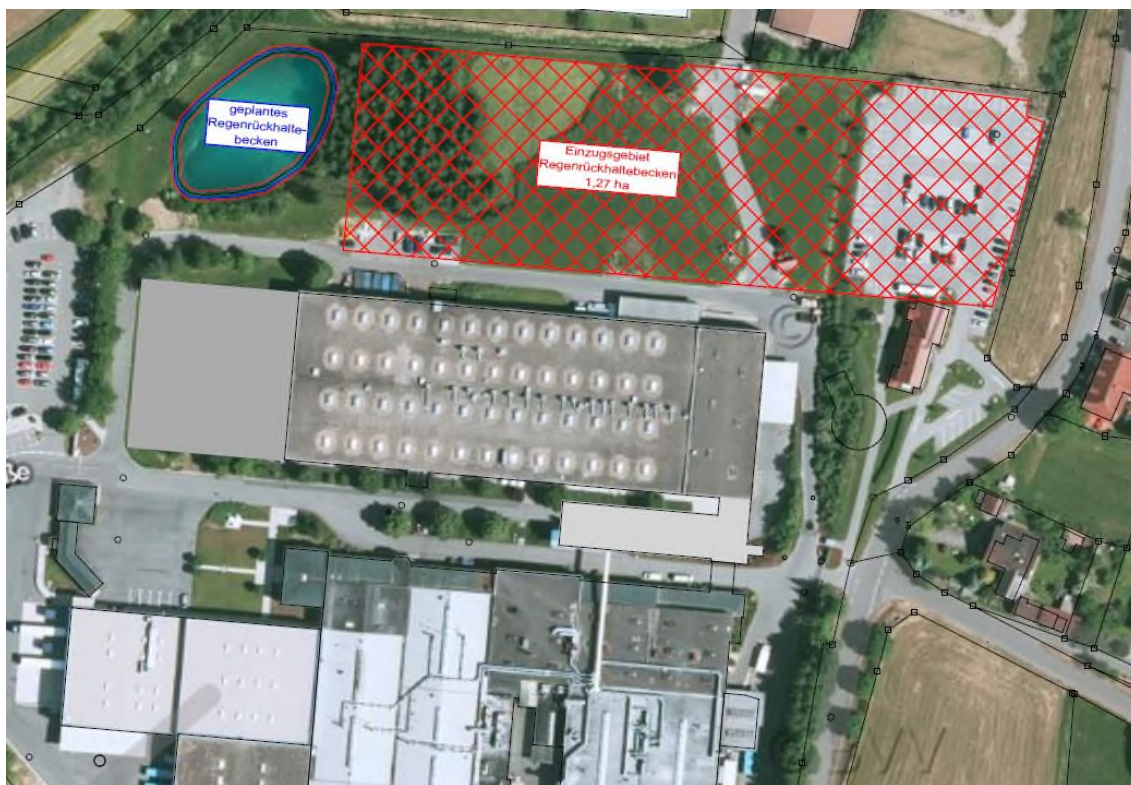
Abb. 4: an das geplante Regenrückhaltebecken anzuschließende Fläche (rot)
